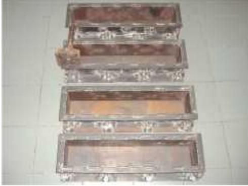
Gambar 1. Cetakan benda uji
